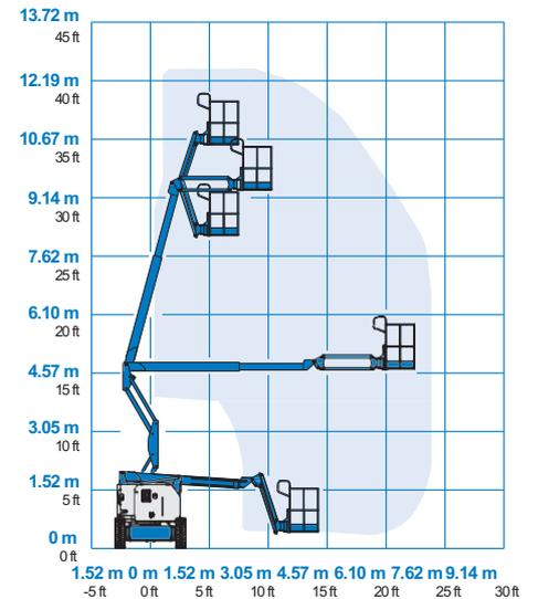
\* En el sistema métrico, altura de trabajo = altura de la plataforma + 2 m.
