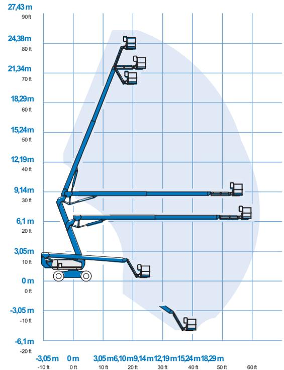
\* En el sistema métrico, altura de trabajo = altura de la plataforma + 2 m.
